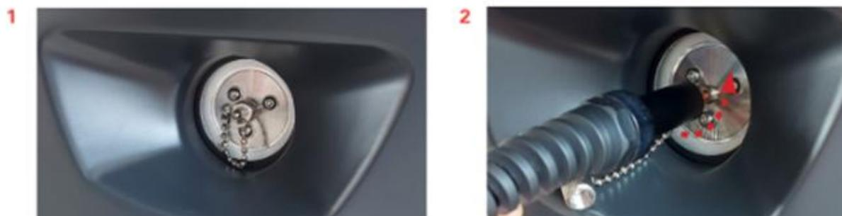
**NOTA** El conector de fibra está protegido por una tapa que debe ser retirada para poder conectar la fibra óptica.
